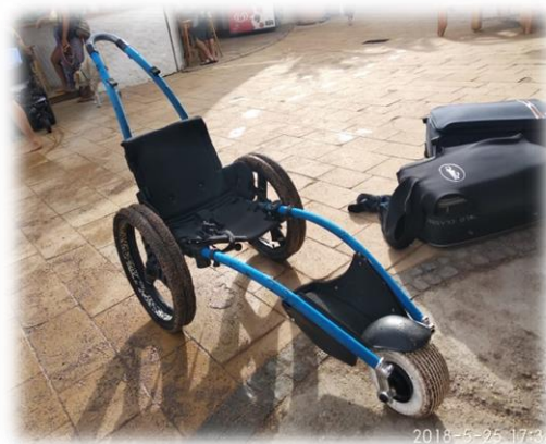
תמונה 4. כסא גלגלים מיוחד המסייע בכניסה למים לצוללים הזקוקים כך
